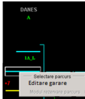
Figura 16 – Funcționalități ale butonului click-dreapta pentru o secțiune neselectată în stație
