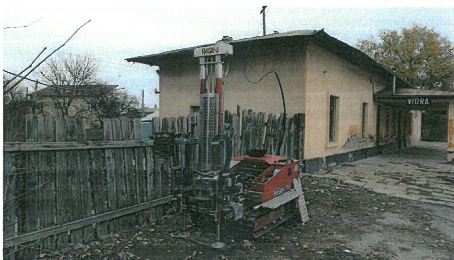
Foto 3.1 Penetrometrul dinamic greu PAGANI TG 63-150 (pe amplasamentul DPHC12)
