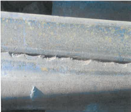
Desprinderi de material la nivelul suprafeței de rulare
