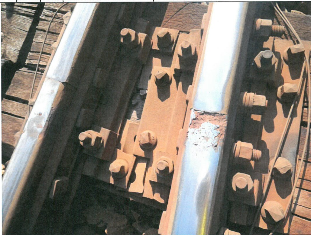
Turtiri ale ciupercii șinei și desprinderi de material la joantă, pe zona aparatului de cale
