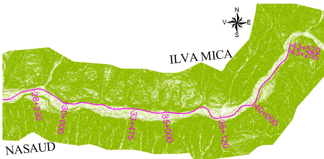
Fig. 8. Plan Curbe de Nivel generate la interdistanta de 2m in zona studiata intre Năsăud si Ilva Mică
