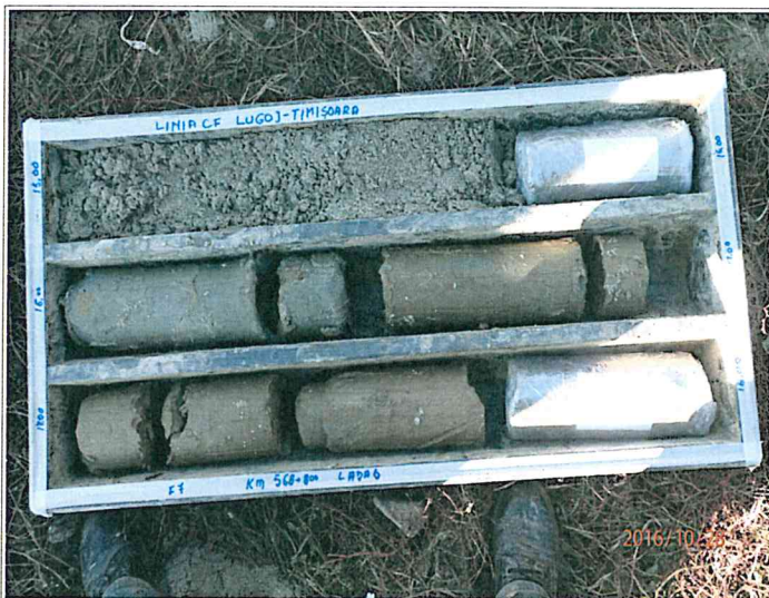
Foto nr.23-Recuperaj km 568+800
