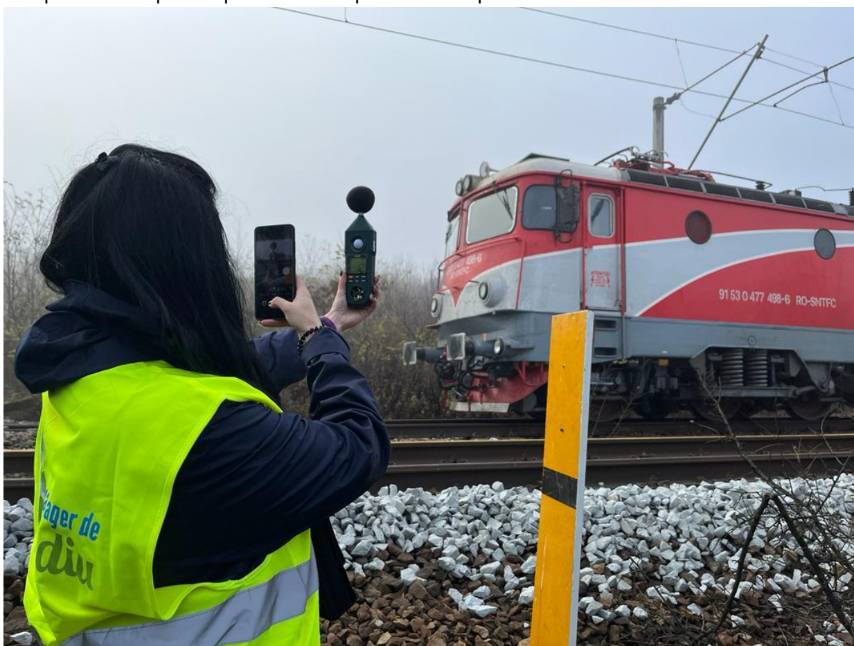
Exemplul unei măsurători instantanee de zgomot, efectuată de către inginerul expert de mediu, în momentul în care o garnitură CFR trece pe linia opusă
