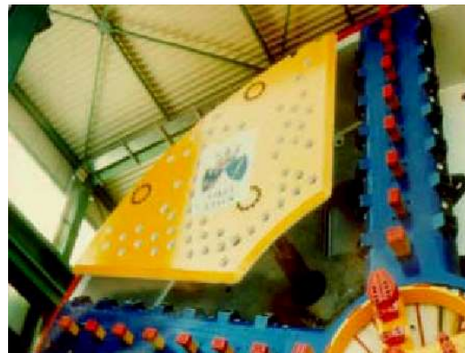
Schema Mixshield. Placi pentru stabilizarea feței și spațiul pentru migrarea noroiului în teren. (din Herrenknecht)
