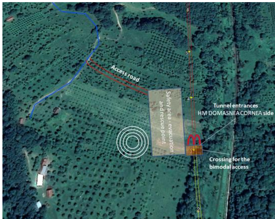
Figura 15. Un aranjament de tip ERP de intrarea în tunel de HM laterale DOMASNEA CORNEA
