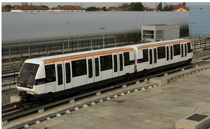
Figura 3.2-16. Exteriorul și interiorul unui vehicul VAL, lungime 26m (Toulouse, France)
