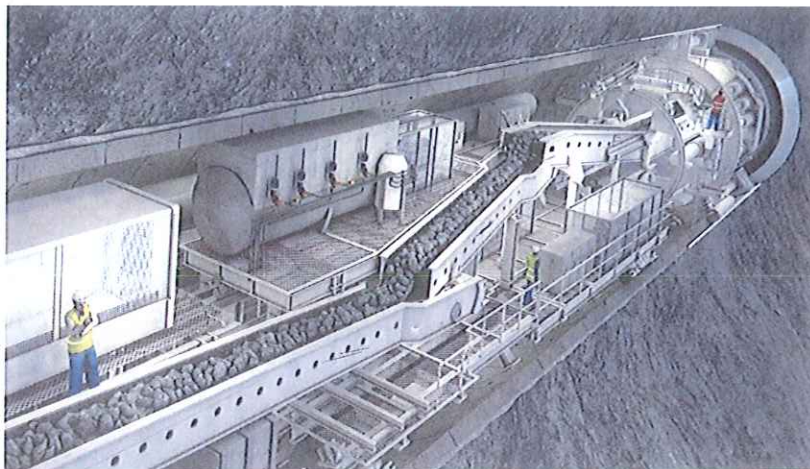
Figura 5.3-57. Benzi transportoare pentru transportul materialului excavat
