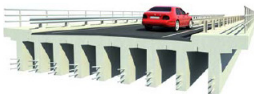
Fig 7. Structura cu grinda din beton precomprimat cu sectiune transversala variabila in forma „I” (tip F)
