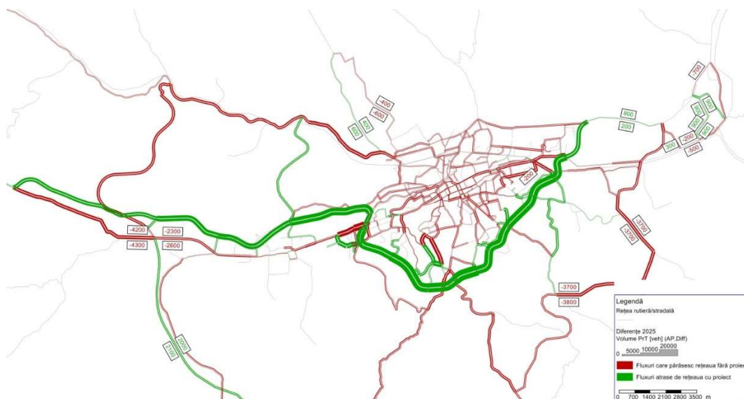
Figura 42 – Redistribuirea traficului total de vehicule în urma apariției Centurii metropolitane Cluj-Napoca și a drumurilor sale de legătură (Drum TransRegio Feleac TR35) - 2025
