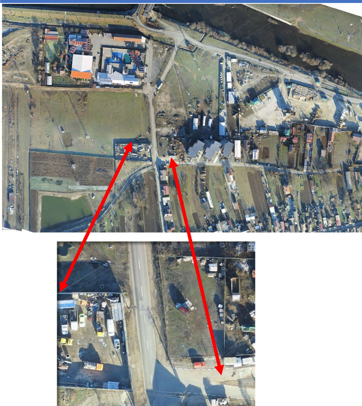
Figura 57 - Ortofotoplan bandă imagini actuale (decembrie 2018) pe traseul TR35 realizat prin zbor de achiziție. Exemplu - extras aceeași zonă din Florești în zona străzii Sportului lângă malul drept a râului Someșul Mic (se observa rezoluția ridică a ortofoplanului realizat prin zbor de achiziție )
